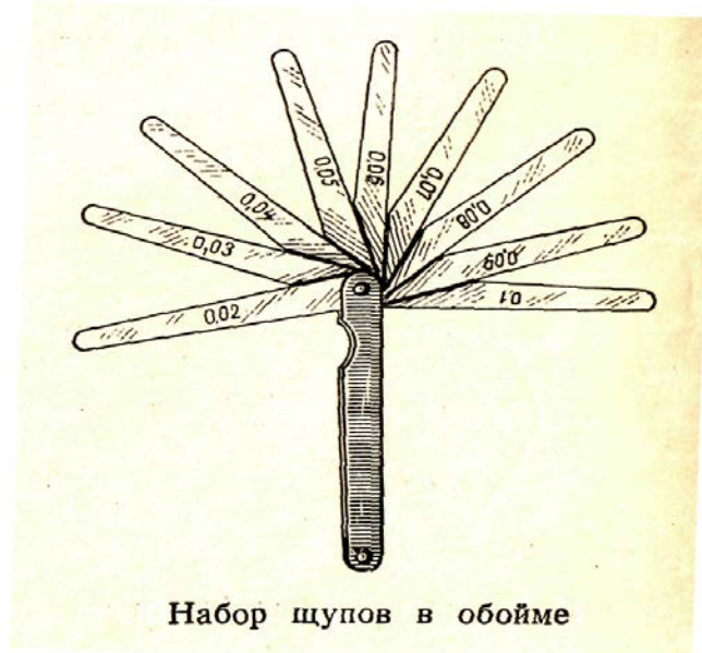
Рис. 6.6. Измерение зазоров при помощи щупа
