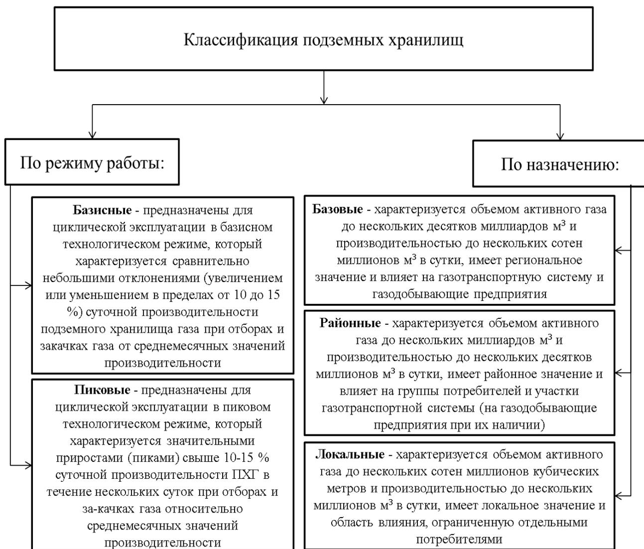
Рис. 29. Схема, описывающая классификацию подземных хранилищ
