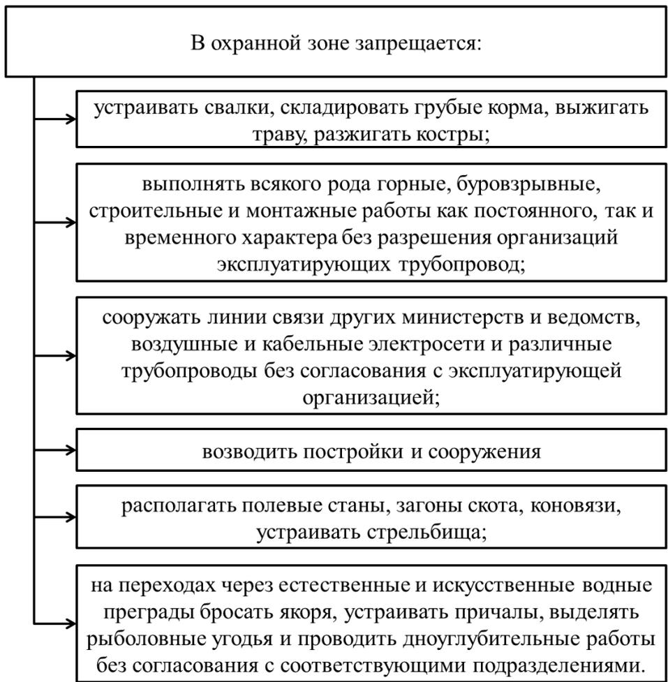
Рис. 26. Схема, описывающая требования к охранным зонам
