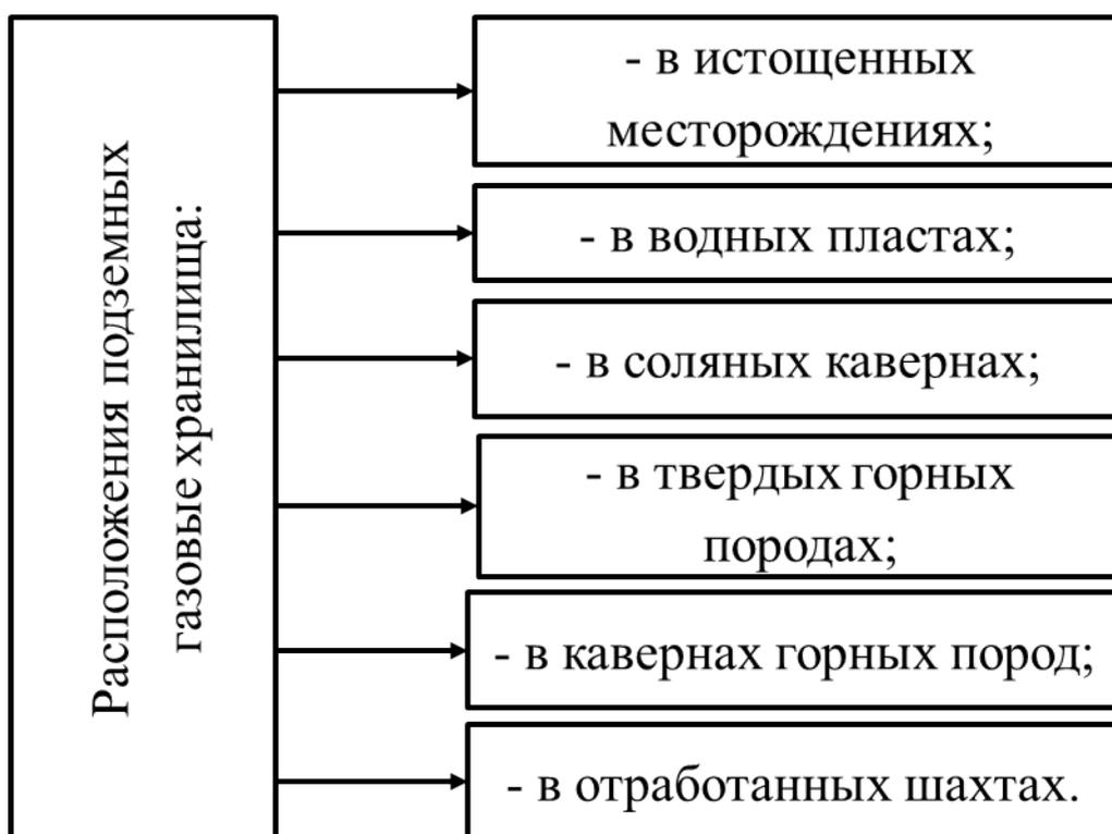
Рис. 30. Схема, описывающая возможные места расположения подземных хранилищ
