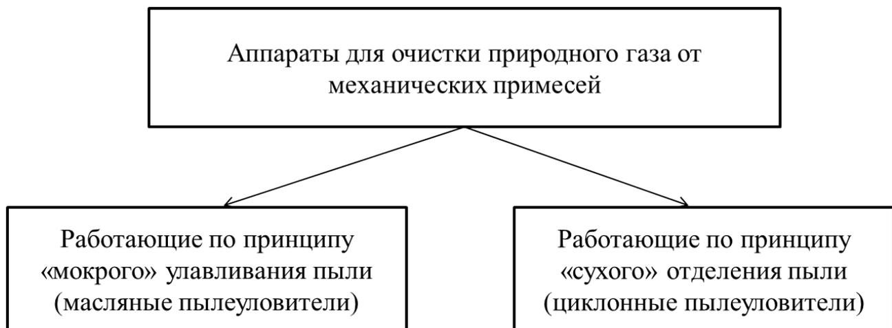
Рис. 13. Схема, описывающая типы аппаратов для очистки природного газа от механических примесей
