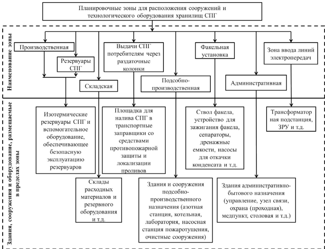
Рис. 38. Схема, описывающая планировочные зоны для размещения сооружений и технологического оборудования хранилищ СПГ
