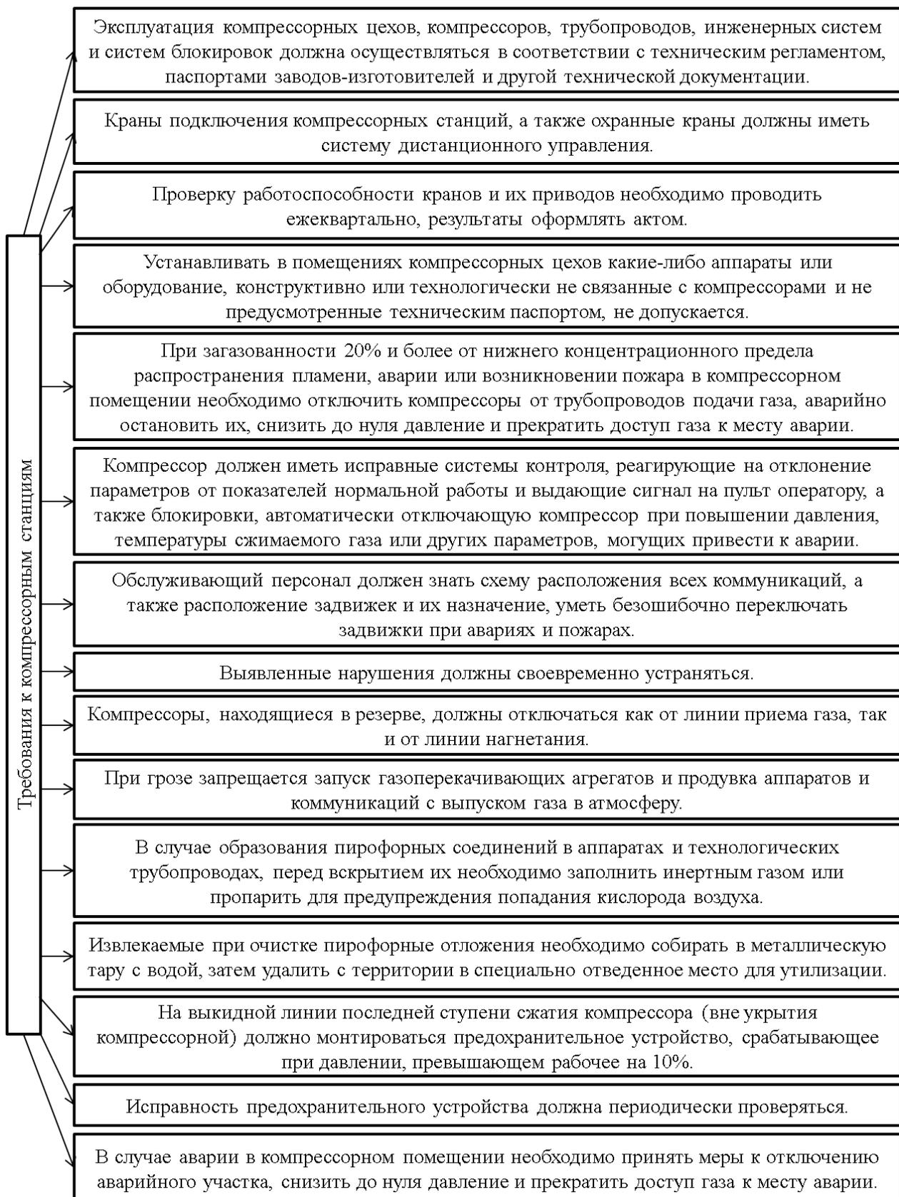
Рис. 23. Схема, содержащая перечень требований к компрессорным станциям
