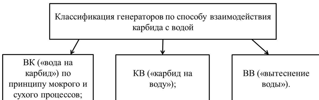
Рис. 45. Схема, описывающая классификацию генераторов по способу взаимодействия карбида с водой
