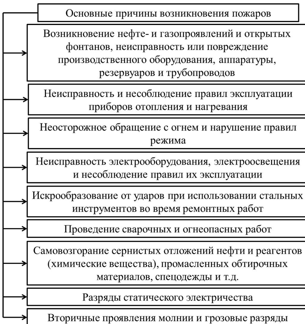
Рис. 10. Схема, описывающая основные причины возникновения пожаров на газодобывающих объектах
