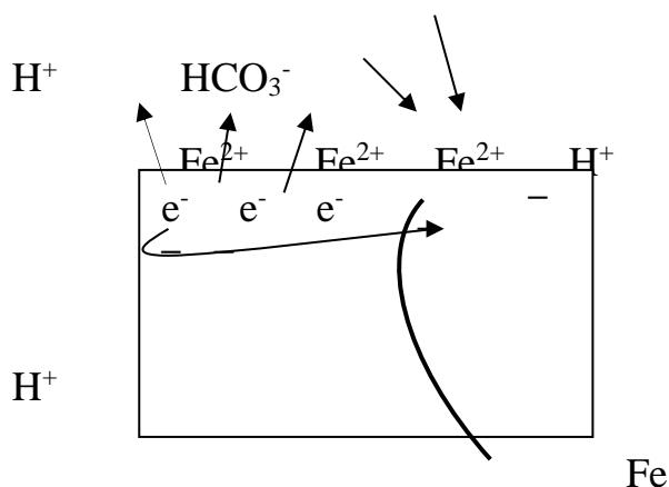
Схема электрохимической коррозии железа в кислой среде
