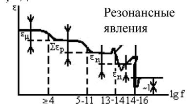
Рис. 5.1. Частотная зависимость диэлектрической проницаемости  $\epsilon$  при различных видах поляризации:  $\epsilon_M$  – миграционной;  $\epsilon_P$  – дипольно- и ионно-релаксационных;  $\epsilon_и$ ,  $\epsilon_э$  – резонансных видов поляризаций
