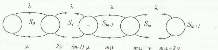
Рис. 35. Размеченный граф системы массового обслуживания
