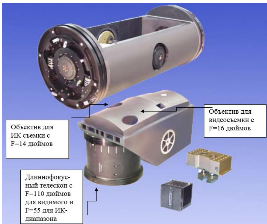
Рис. 3.12. Упрощенная версия оптико-электронной аппаратуры воздушной разведки
