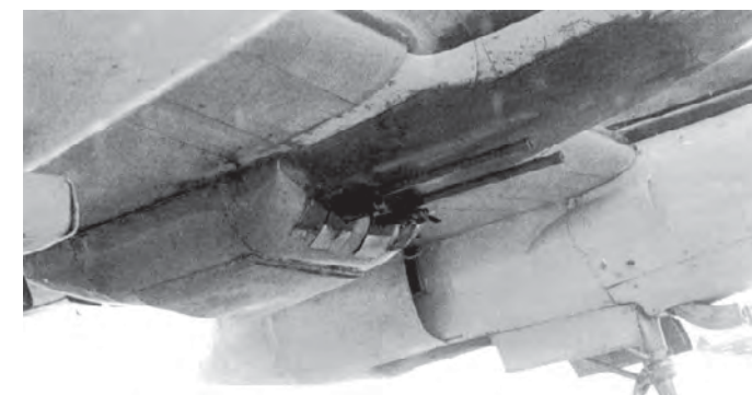
На бомбардировщике Як-2 установка КАБ-2МВ — комбинированная артиллерийско- бомбардировочная батарея Можаровского и Веневидова, 1941 год
