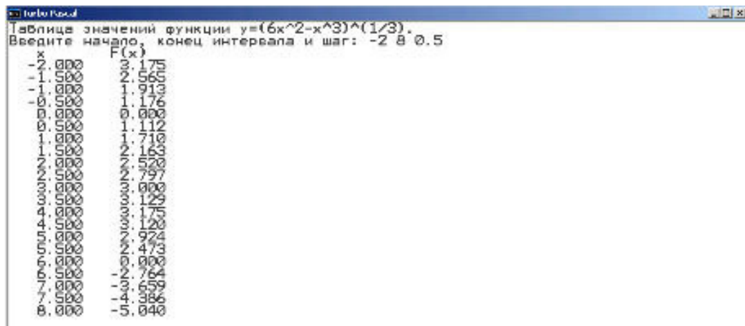
Рис.1.3. Программная реализация задачи табулирования функции с использованием счетного оператора цикла
