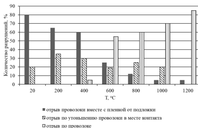
Рис.3- Гистограмма распределения видов разрушений микросоединений платиновая проволока – пленка платины в зависимости от температуры отжига проволоки
