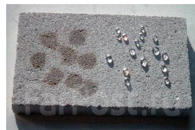
Рис. 3. Пример работы состава на каменного материала
