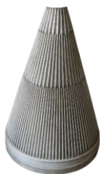
Рис. 1 – Макет конструкции конуса стекателя, состоящего из трех секций, с гофровым заполнителем
