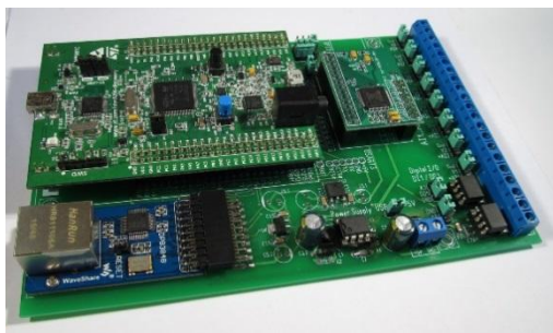
Рис.1. Общий вид аппаратной части высокоскоростной системы сбора данных
