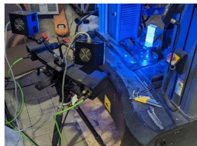
Рис. 2 – Общий вид испытания ауксетика с повторно-входящей структурой
