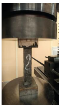
Рис.1. Контрольный образец на сжатие
