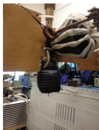
Рис. 1 -Индуктор с сердечником, закрепленный на сварочной горелке
