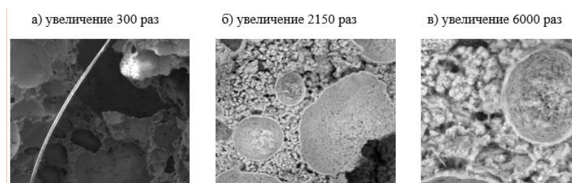
Микроструктура фибропенобетона с полиамидным волокном длиной 12 мм
