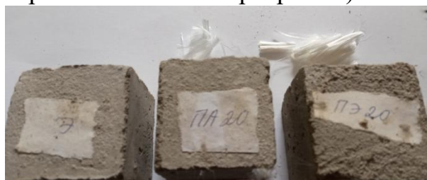
Образцы с фиброволокном различного типа и расхода, фиброволокно
