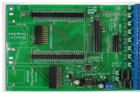
Рис.2. Общий вид базовой платы высокоскоростной системы сбора данных
