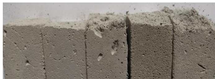
Образцы с фиброволокном различного типа и расхода, фиброволокно
