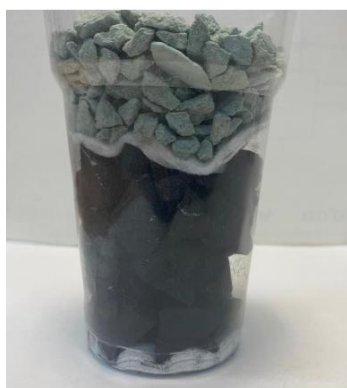
Рис. 2- Фильтр для очистки сточных вод
