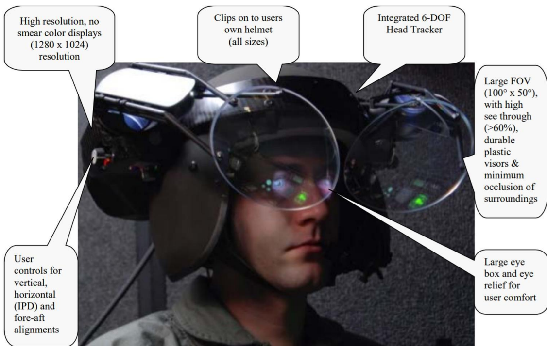
Рис. 6. Оптическая система нашьлемного индикатора
