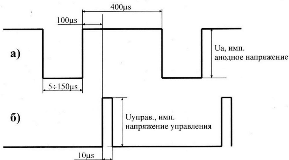
Рис. 4. Временные диаграммы генераторов импульсов
