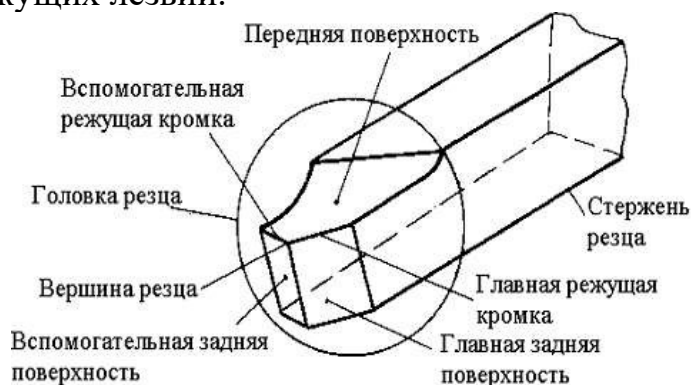
Рис. 4.2. Элементы режущей части прямого проходного резца
