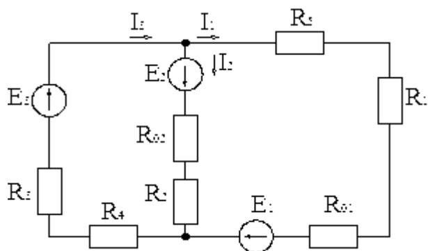
5. В каких режимах работают электрические машины с ЭДС  $E_1$  и  $E_2$ ? Определите токи в цепи. Дано:  $E_1=E_2=240$  В;  $R_3=30$  Ом.
