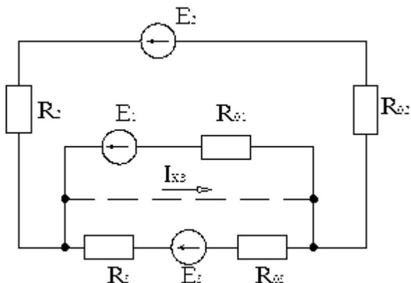
4. Запишите уравнение энергетического баланса для цепи. Определите мощности, отдаваемые источником  $E_3$  и потребляемые приемниками  $E_2$  и  $R_5$ . Дано:  $E_1=100$  В;  $E_2=24$  В;  $E_3=12$  В;  $R_{01}=0,6$  Ом;  $R_{02}=0,2$  Ом;  $R_1=4,4$  Ом;  $R_2=3,8$  Ом;  $R_3=2$  Ом;  $R_4=12$  Ом;  $R_5=6$  Ом;  $I_1=5,95$  А;  $I_2=-2,63$  А;  $I_3=3,32$  А.
