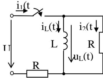
10. Катушка, индуктивность которой равна  $0,12\text{ Гн}$  и сопротивление  $1\text{ Ом}$ , включается на постоянное напряжение  $30\text{ В}$ . Чему равна постоянная времени этой катушки? С какой скоростью нарастает ток в начальный момент? Чему равно установившееся значение тока?
