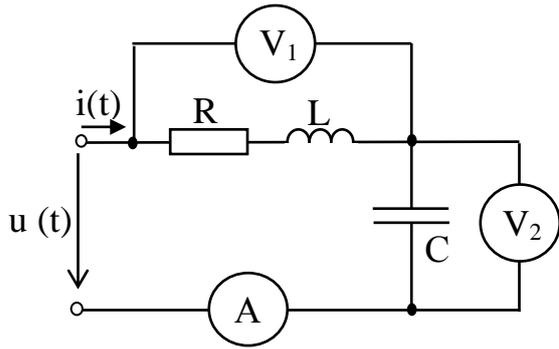
8. Определить показания приборов электромагнитной системы в цепи, схема которой показана на рисунке, записать выражение мгновенного значения тока, если:  $R=50\text{ Ом}$ ,  $\omega L=10\text{ Ом}$ ,  $\frac{1}{\omega C}=90\text{ Ом}$ . На вход цепи подано несинусоидальное напряжение, заданное в виде аналитического разложения
