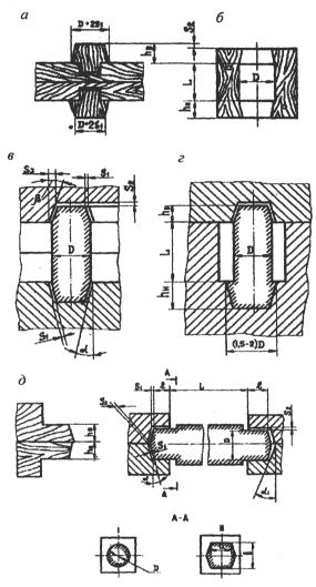
Рис. 2. Размеры и форма вертикальных и горизонтальных стержневых знаков: a - знаковые части модели;  $\delta$  - знаковые части стержневого ящика;  $\epsilon$ ,  $\epsilon$  и  $\delta$  - зазоры в форме для вертикальных и горизонтальных знаков
