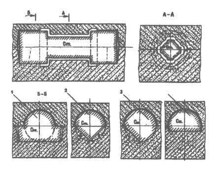
Рис.4. Фиксаторы горизонтально расположенных стержней
