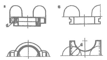
Рис. 12. Схемы установки прибылей на узлах отливки: а - разветвленном; б - концентрированном
