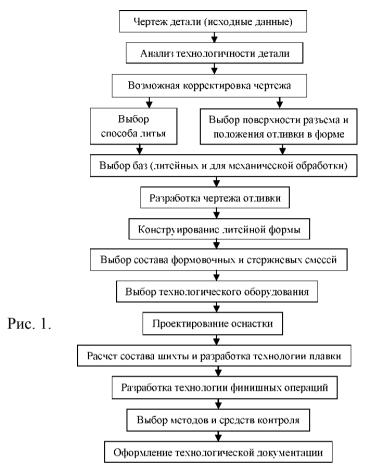
Последовательность разработки технологического процесса изготовления отливки
