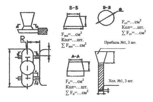
**Прибыль** обозначают порядковым номером на полке линии-выноски, перед которым записывают слово "Прибыль". Если на отливке несколько одинаковых прибылей, то им присваиваются одинаковые номера и на полке линии-выноски после номера прибыли указывают общее количество устанавливаемых прибылей этого номера.
