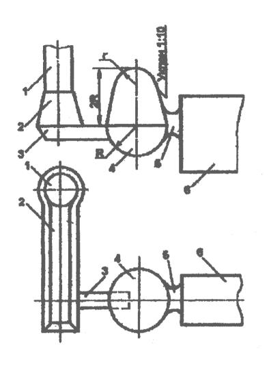
Рис. 13. Питающие бобышки для отливок из ковкого чугуна: 1 - стояк; 2 - шлакоуловитель; 3 - питатель; 4 - бобышка; 5 - шейка; 6 - отливка
