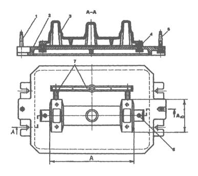
Рис. 15. Схема расположения моделей на модельной плите: 1 - штырь центрирующий; 2 - односторонняя модельная плита; 3 - верхняя половина модели; 4 - крепежный болт; 5 - штырь направляющий; 6 - контрольный штифт; 7 - модели литниковой системы
