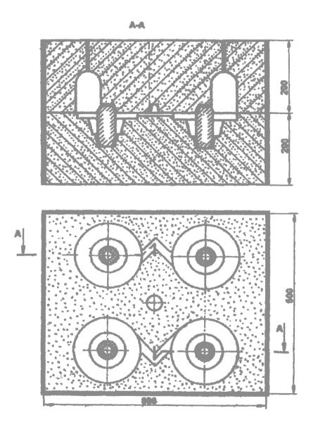
Рис. 17. Эскиз формы в сборе
