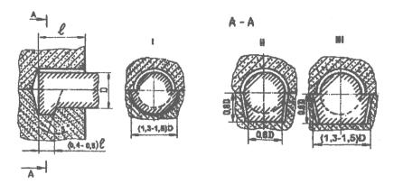
Рис. 3. Конструкции фиксаторов
