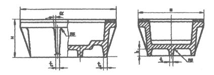
Рис. 16. Конструкция алюминиевого стержневого ящика
