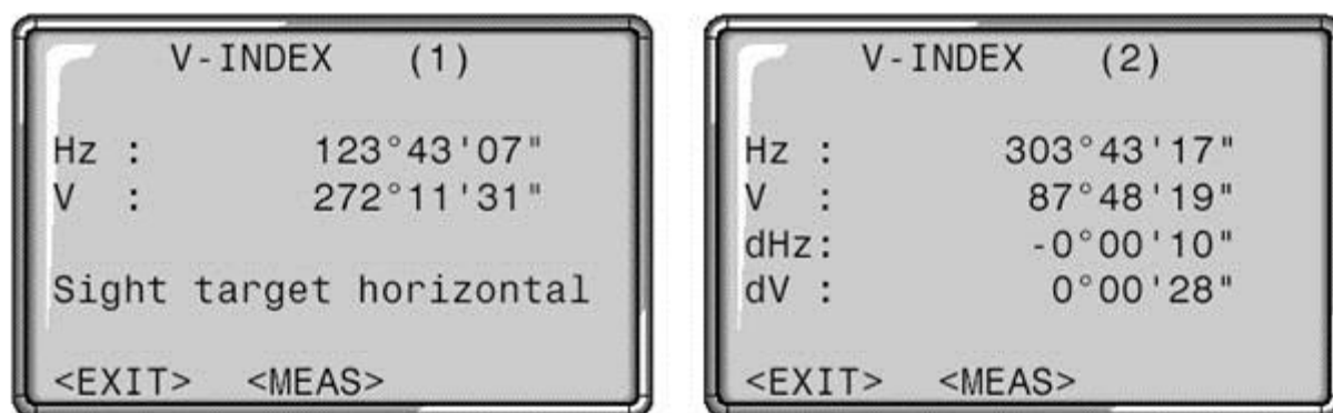
Рис. 25. Отсчёты по вертикальному кругу при КЛ и КП
