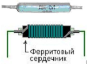
Рисунок 1 - Внешний вид и устройство катушки индуктивности
