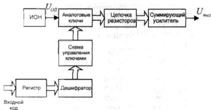
Рис. 4.12. Структурная схема ЦАП
