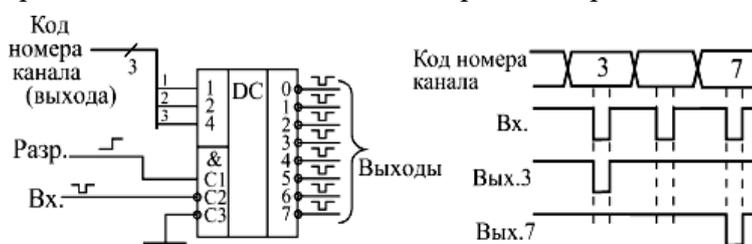
Рис. 6.9. Включение дешифратора как демультиплексора
