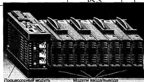
Рис. 1.27. Внешний вид контроллера серии Compact Field Point
