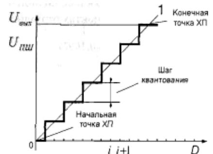
Рис. 4.25. Статическая характеристика преобразования ЦАП
