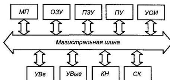
Рис. 1.20. Структурная схема программируемого контроллера
