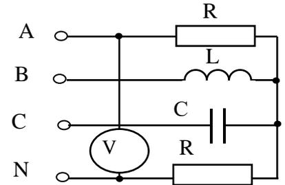
7. Определить токи в цепи, если источник питания симметричен и  $R = \omega L = 1/\omega C = 2$  Ом;  $U_v = 20$  В.
