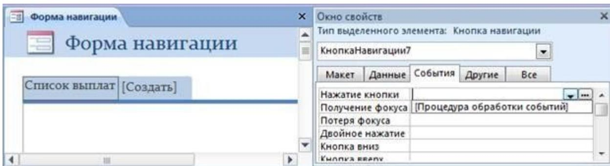
Рис. 16. Назначение процедуры обработки события для кнопки
