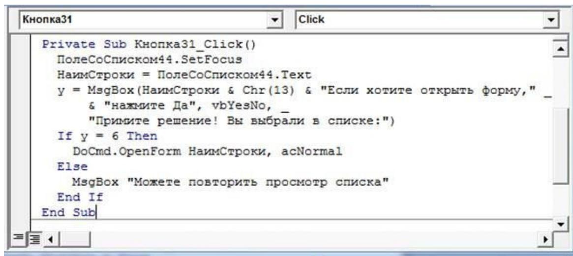
Рис. 58. Процедура обработки события – нажать на кнопку
