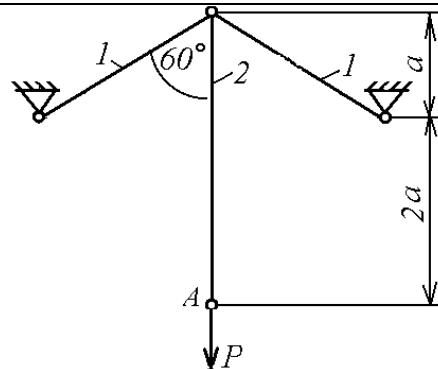
7. Определить площадь поперечного сечения стального стержня и перемещение точки А при  $[\sigma] = 160$  МПа,  $P_1 = 20$  кН,  $P_2 = 20$  кН, если  $E = 2 \cdot 10^5$  МПа,  $a = 0,5$  м.
