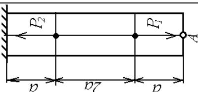
8. Определить допускаемую нагрузку  $P$  на систему симметричную систему стержней, если  $E_1 = 2 \cdot 10^5$  МПа,  $F_1 = 10 \text{ см}^2$ ,  $E_2 = 10^5$  МПа,  $F_2 = 20 \text{ см}^2$ ,  $[\sigma]_1 = 160$  МПа,  $[\sigma]_2 = 60$  МПа.
