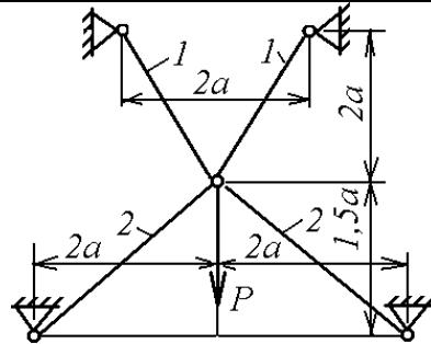
9. Стержень, изображенный на схеме, закреплен при  $t = -10^\circ\text{C}$ . Определить напряжения при нагреве стержня на  $100^\circ\text{C}$  при  $a = 0,2$  м. Модули упругости меди и стали равны  $E_1 = 1.1 \cdot 10^5$  МПа,  $E_2 = 2 \cdot 10^5$  МПа,  $F = 2 \text{ см}^2$ . Для стали коэффициент температурного расширения равен  $1.25 \cdot 10^{-5}$  1/град, для меди  $-2.5 \cdot 10^{-5}$  1/град.
