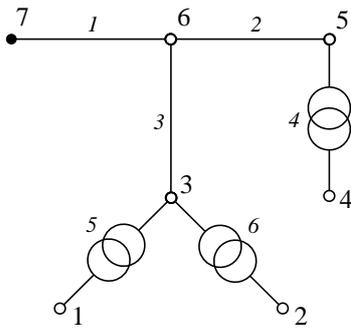
Ветви 1, 2 и 3 графа – это линии электропередачи 110 кВ, выполненные проводом марки АС-120/19 с погонными параметрами  $r_0 = 0,249$  Ом/км;  $x_0 = 0,427$  Ом/км;  $b_0 = 2,6$  мкСм/км. Три двухобмоточных трансформатора имеют номинальные напряжение обмоток высшего и низшего напряжения соответственно 115 и 11 кВ.
