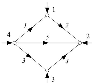
– В программе SmathStudio рассчитайте напряжения в узлах и потоки мощности в ветвях схемы сети, граф которой изображен на рисунке по заданным параметрам.
