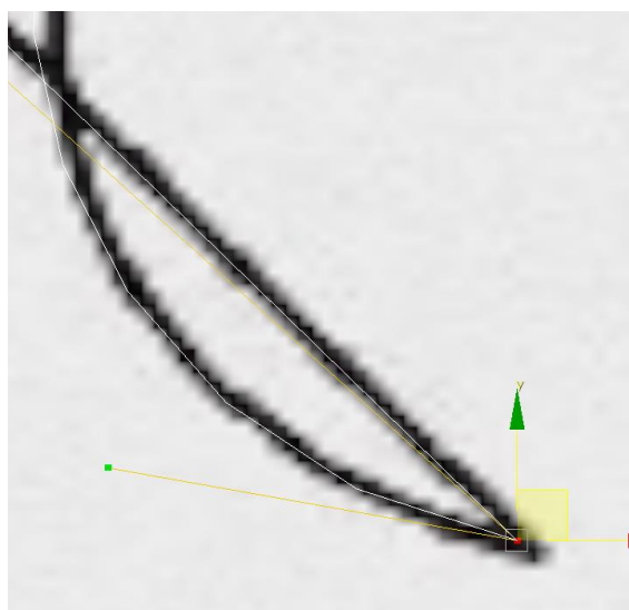
Рис. 23. Подгонка сплайна под контур эскиза
