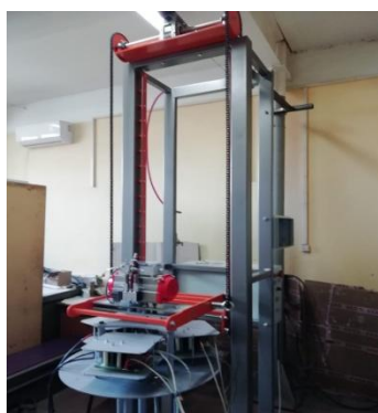
Установка с возвратно-поступательным механизмом, позволяющая разогреть бочку за время чуть больше часа
