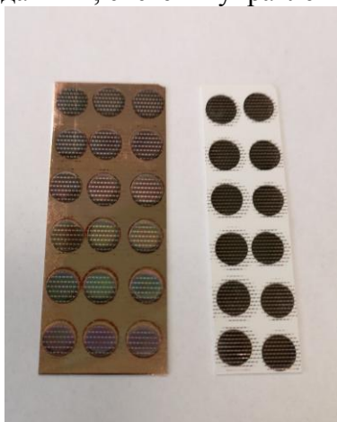
Внешний вид мемристивных элементов (\text{CoFeB})_x(\text{LiNbO}_3)_{100-x} на кремниевой подложке (слева) и ситалловой подложке (справа)
