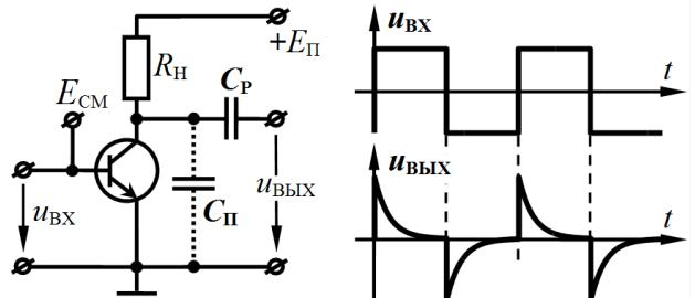
**Задание 0434.** Представленную на рисунке схему предполагается использовать в качестве удвоителя частоты. Входное напряжение определяется выражением  $u_{\text{ВХ}}(t) = 0.5 \cdot \cos(2\pi \cdot 10^4 \cdot t)$ , В. Чтобы удвоение частоты имело место и происходило наиболее эффективно, частота настройки контура должна быть равна ... кГц, а угол отсечки, при котором работает схема, – ... градусов.
