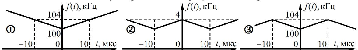
**Задание 0210.** На рисунке слева показан сигнал на выходе идеального фазового модулятора. Управляющий набегом фазы информационный сигнал на входе модулятора изображен на рисунке справа под номером ....
