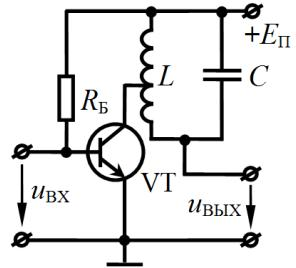
**Задание 0301.** Крутизна  $S$  проходной вольтамперной характеристики транзистора, на котором построен линейный усилитель, равна  $10 \text{ мА/В}$ . Эквивалентное резонансное сопротивление нагрузочного колебательного контура –  $R_{\text{КО}} = 15 \text{ кОм}$ . Коэффициент усиления на резонансной частоте такого усилителя составляет ....
