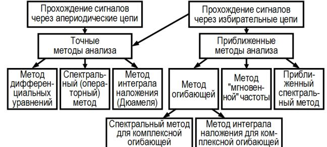
**Задание 0317.** На рисунке показана краткая классификация методов анализа линейных цепей. Один из указанных методов основан на представлении сигнала в виде совокупности комплексных гармонических колебаний разных частот и использовании комплексной частотной характеристики цепи. Это метод ...
