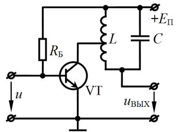
**Задание 0502.** На рисунке показан усилитель, охваченный последовательной обратной связью по напряжению. Входное сопротивление усилителя бесконечно велико, выходное – бесконечно мало, коэффициент усиления  $K_0 = 100$ . Коэффициент передачи цепи, посредством которой реализуется обратная связь, на частоте  $\omega_1$  равен  $\beta(\omega_1) = -0.04$ . При таких условиях коэффициент усиления цепи с учетом обратной связи на частоте  $\omega_1$  составляет ....
