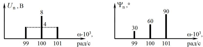
**Задание 0206.** На идеальный частотный модулятор с крутизной  $k_{\text{ЧМ}} = 8000 \text{ рад/(В}\cdot\text{с)}$  поступает высокочастотное колебание  $s_H(t) = 4 \cdot \cos(2 \cdot 10^6 \cdot t) \text{ (В)}$  и информационный сигнал, показанный на рисунке. Девиация частоты колебания на выходе модулятора составляет ... рад/с.
