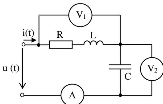
8. Определить показания приборов электромагнитной системы в цепи, схема которой показана на рисунке, записать выражение мгновенного значения тока, если:  $R= 50$  Ом,  $\omega L=10$  Ом,  $\frac{1}{\omega C} = 90$  Ом. На вход
