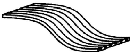
Рис. 1.5. Гибкий печатный кабель [3, с. 24]
