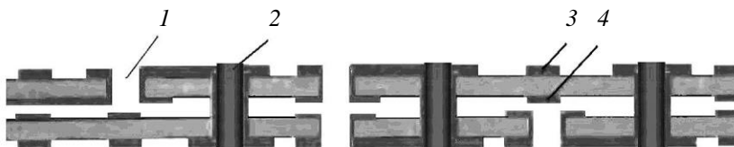
Рис. 1.12. Простейший вариант структуры МПП попарного прессования [33]:
