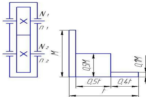
Рис. 1 Схема редуктора и график нагрузки
