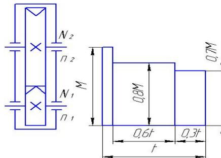
Рис. 5 Схема шевронного редуктора и график нагрузки
