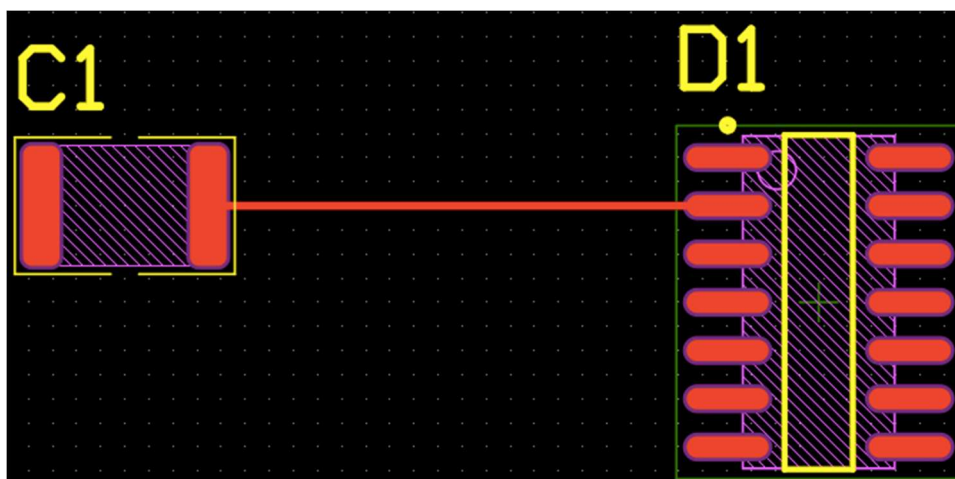
Рис. 155. Пример неоптимального соединения дорожек
