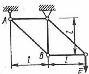
Определить усилие в стержне  $AB$ . Сила  $F = 300$  Н.
