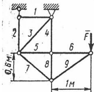
Определить усилие в стержне 5. Сила  $F = 480$  Н.
