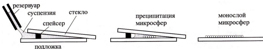
Рис. 7.4. Схема формирования однослойного массива сферических наночастиц на поверхности плоской подложки
