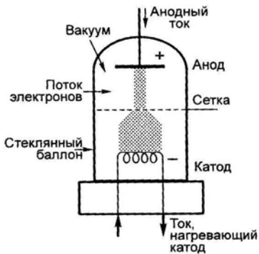
Рис. 1.1 Схематическое представление трехэлектродной лампы (триод)
