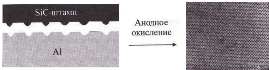
Рис. 7.16. Схема получения упорядоченного ПАОА с применением наноимпринтинга
