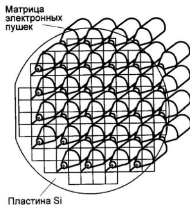
Рис. 4.6. Схема матрицы параллельных электронных пучков для прямого нанесения рисунка на пластину
