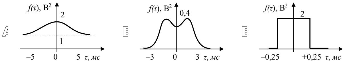
Какие из представленных зависимостей не могут служить корреляционными функциями случайных процессов и почему? Для графиков, соответствующих возможным корреляционным функциям СП, укажите, как они изменятся, если математическое ожидание СП сделать равным минус 1 вольту?
