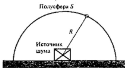
Рис. 11.1. Измерительная полусфера
