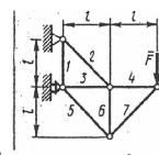
Определить усилие в стержне 3. Сила F = 460 H.
