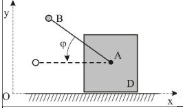
Стержень l=1 м, несущий на конце шарик B массой  $m_B=10$  кг может вращаться вокруг оси A. Брус D массой  $m_D=90$  кг находится на гладкой горизонтальной плоскости. Массой стержня пренебречь. В начальный момент система покоилась. Чему равна проекция перемещения бруса на ось Ox, если стержень из начального положения  $\varphi=60^0$  перейдёт в горизонтальное.
