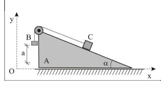
Брус C скользит по боковой поверхности призмы A, поднимая при мощи троса груз B. В начале система находилась в покое, трение не учитывается. Дано:  $m_A = 170$  кг,  $m_B = 10$  кг,  $m_C = 20$  кг;  $\alpha = 60^{\circ}$ . Чему равна проекция перемещения призмы A на ось Ox после того, как груз B поднимется на высоту a = 2 м.
