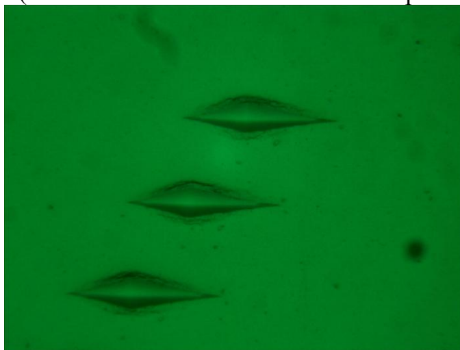
Рис.4. Фрагмент отпечатков микротвердости с использованием пирамиды Кнупа
