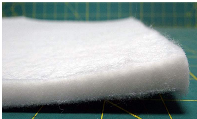
Рис. 3. Утеплитель на основе аэрогеля
