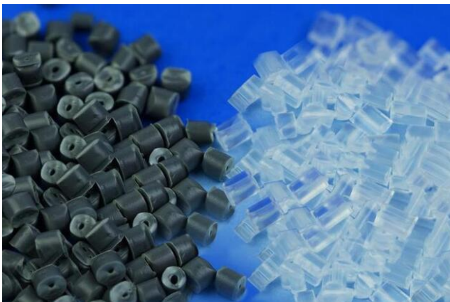
Рис. 2. Черные полипропиленовые гранулы, изготовленные из переработанных ковровых волокон, очищаются и превращаются в прозрачные капсулы с помощью процесса PureCycle
