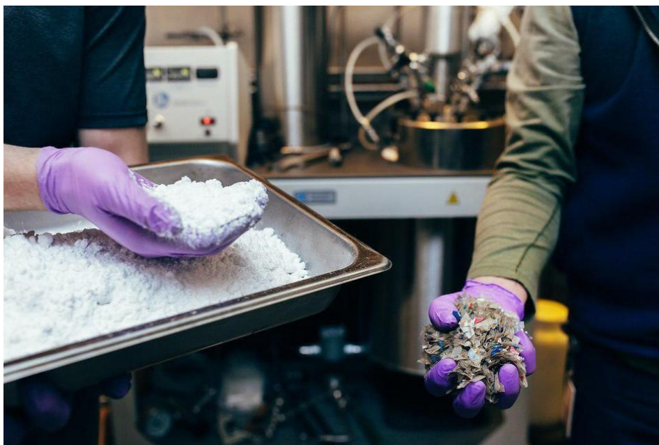
Рис. 4. Порошок, получающийся в процессе технологии PureCycle, можно использовать, как сырье для производства пластика
