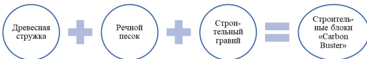
Рис. 2. Состав строительных блоков «Carbon Buster»
