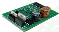
Блок преобразования сигнала для интеграции с пультом управления
