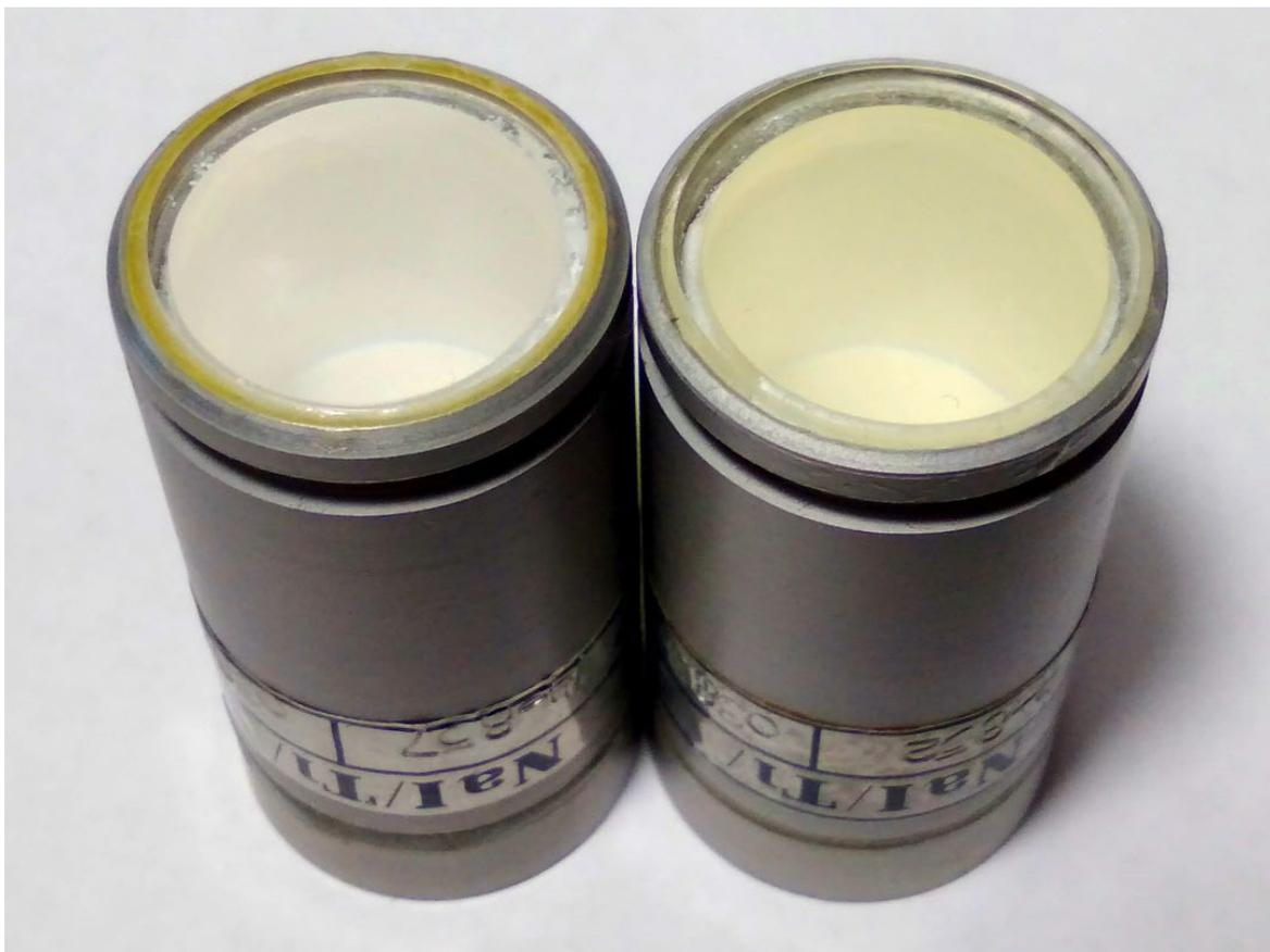
Рис. 4. Сцинтилляционный детектор хорошего качества (слева) и плохого (справа)
