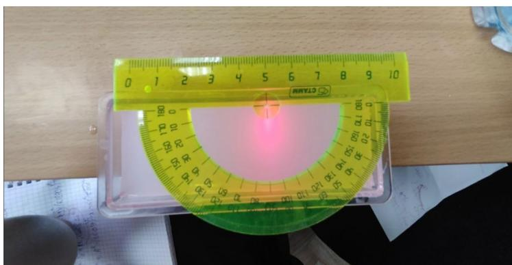
Сечение рассеяния так же можно посчитать прибегнув к элементарной геометрии, поскольку в пространстве рассеянный свет представляет из себя конус с высотой равной ширине тары с коллоидом (3.5 см), то площадь основания этой фигуры можно найти зная половину угла образованную двумя равными сторонами
