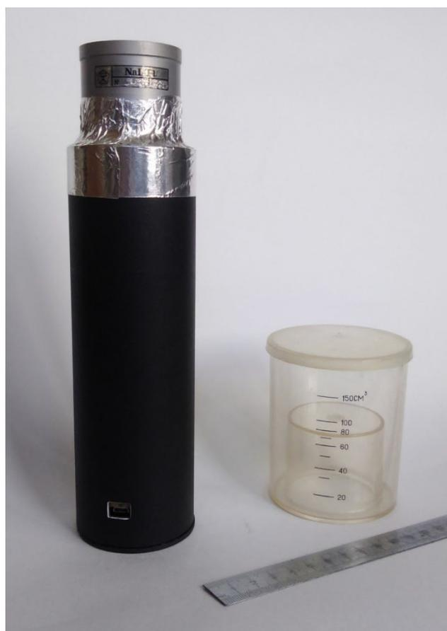
Рис. 21. Опытный образец гамма-спектрометра
