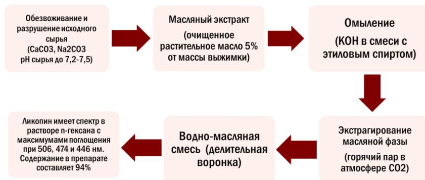
Рисунок 15. Технологическая схема способа получения ликопина
