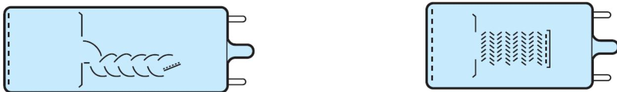
Рис. 5. ФЭУ с ковшеобразными динодами (слева) и с жалюзийной умножительной системой (справа)
