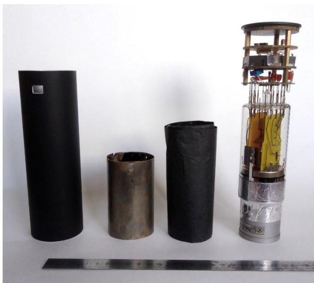
Рис. 20. Основные конструкционные элементы гамма-спектрометра
