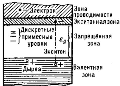
Рис. 3. Зонная диаграмма ионного кристалла
