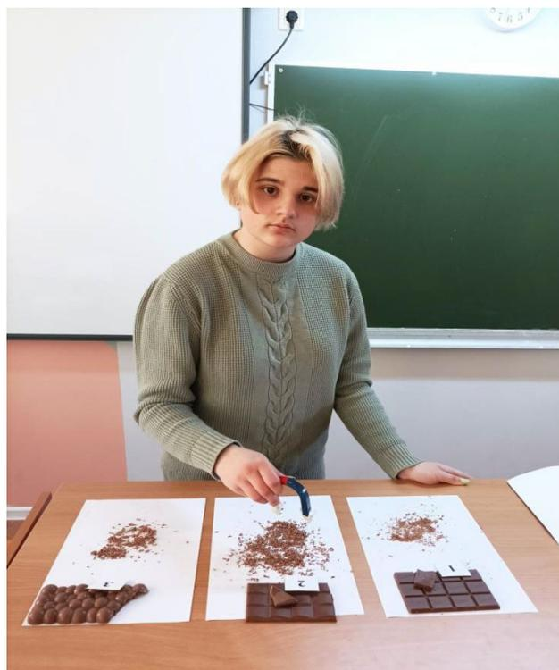
Рис. 12. Определение металломагнитной смеси. Март 2023 г.
