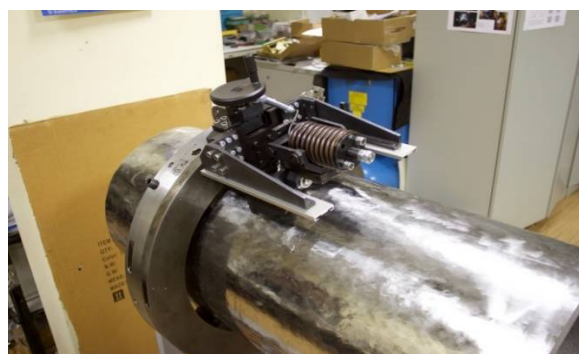
Рис. 4. Установка для поверхностного упрочнения зоны повреждения сварных соединений \varnothing 426 \times 40
