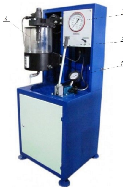
Рис. 3. Стенд для испытаний форсунок: 1 – манометр; 2 – рукоятка ручного насоса; 3 – дроссель регулировки давления; 4 – бак
