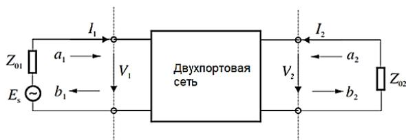
Рис. 1. Двухпортовая сеть, учитывающая сетевые переменные
