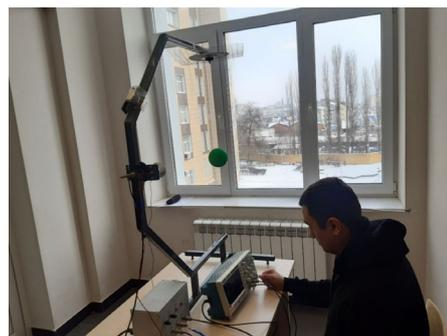
Рис. 2. Лабораторный стенд для измерения ДОР
