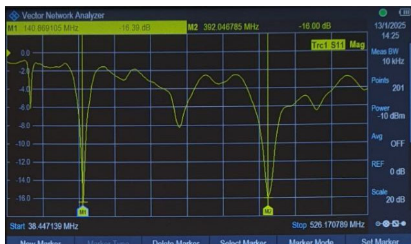
Рис. 5. Измерение параметров антенны векторным анализатором цепей
