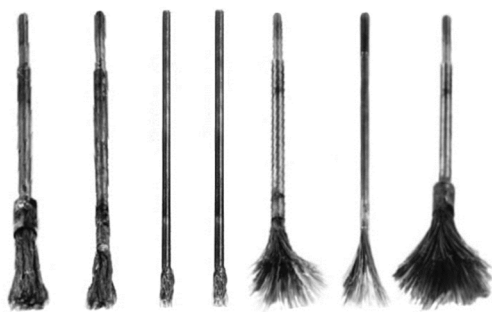
Рис. 2. Непрофилированные электроды инструменты в форме щеток-кисточек с разной степенью набивки и геометрией рабочей части
