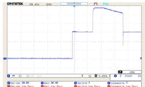
Рис. 4. Напряжение холостого хода выше нормы ( $U_{\text{хх}} > N$ )
