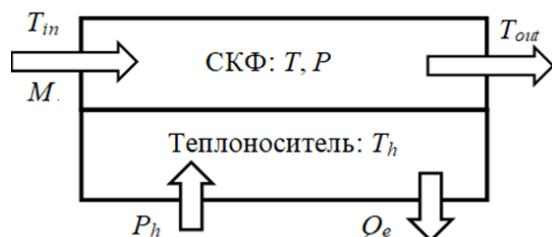
Рис. 1. Схема входных и выходных параметров модели теплообмена,  $Q_e$  – тепловой поток во внешнюю среду
