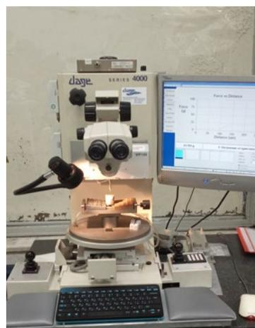
Рис. 2. Установка Dage 4000Plus
