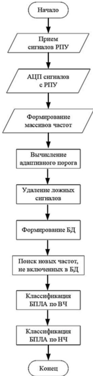
Рис. 4. Структурная схема методики приема, обработки и распознавания радиосигналов
