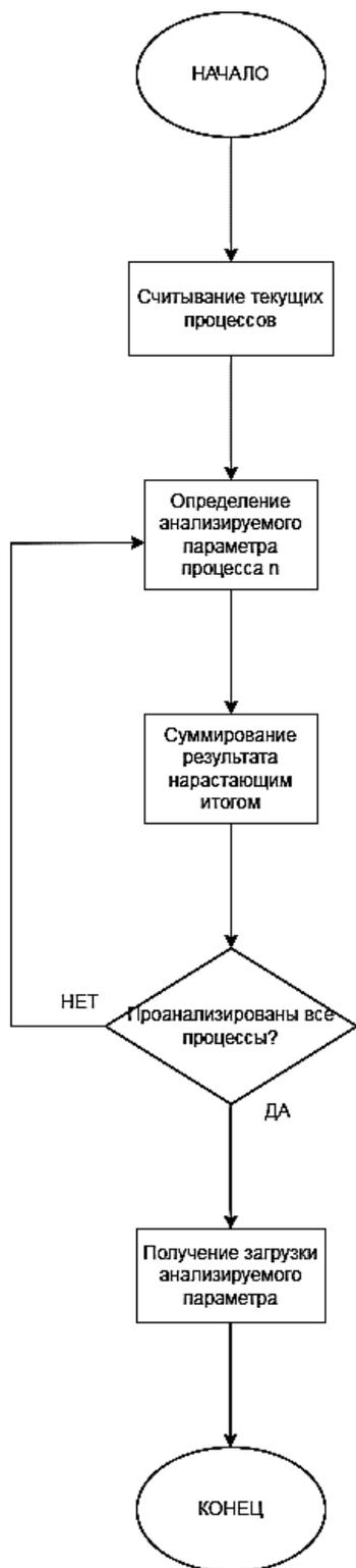
Рис. 4. Алгоритм анализа нагрузки с использованием процессов
