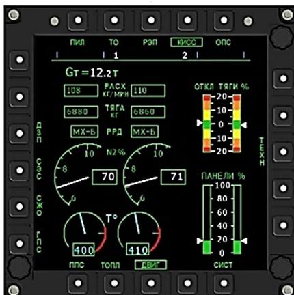
Рис. 5. Индикатор современного АК индикации параметров работы силовой установки с дополнительными элементами
