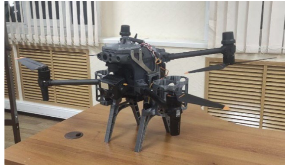
б) БПЛА с установленным сбросом в процессе наладки
