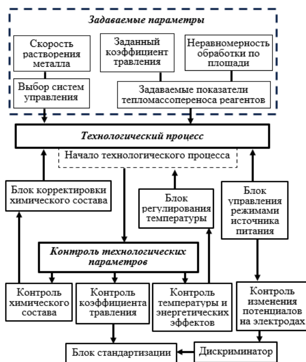
Рис. 6. Оптимизационная схема технологического процесса анодной обработки титановых и алюминиевых сплавов
