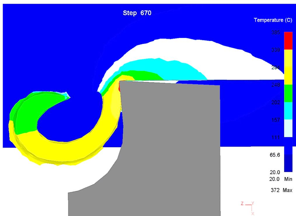
Рис. 2. Результаты моделирования температуры в зоне резания шпоночной протяжкой в Deform 3D
