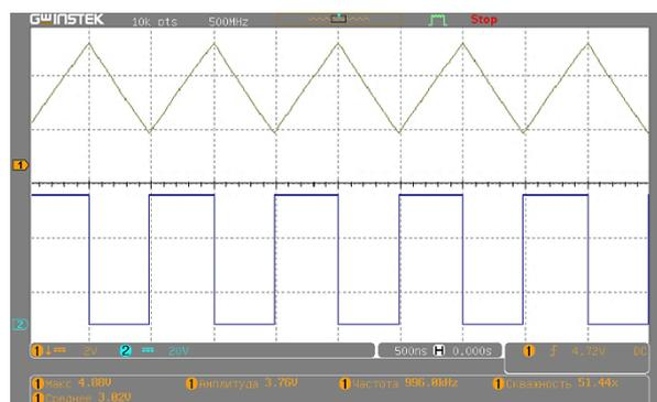
Рис. 3. Осциллограммы тока в дросселе (1) и напряжения сток-исток верхнего ключа (2)
