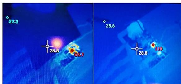
Рис. 4. Значение температуры верхнего (а) и нижнего (б) транзистора в рабочем режиме
