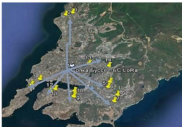
Рис. 4. Схема перемещения приемного модуля относительно БС
