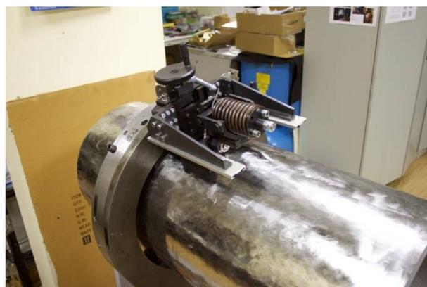
Рис. 5. Установка для поверхностного упрочнения зоны повреждения сварных соединений  $\varnothing 426 \times 40$
