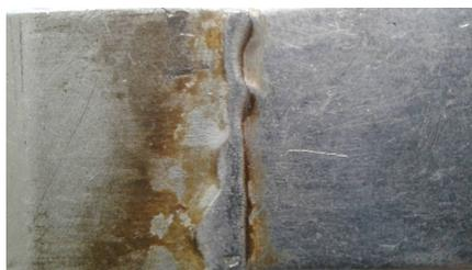
Рис. 4. Выступы и впадины на образце из сплава ВД17 после эрозионно-химической обработки
