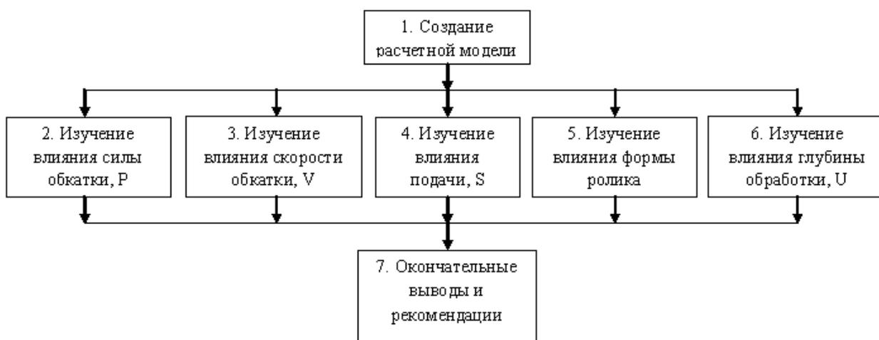
Рис. 1. Блок-схема проведенных расчетных исследований
