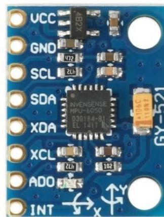
Рис. 1. Внешний вид модуля GY-521 с микросхемой MPU6050
