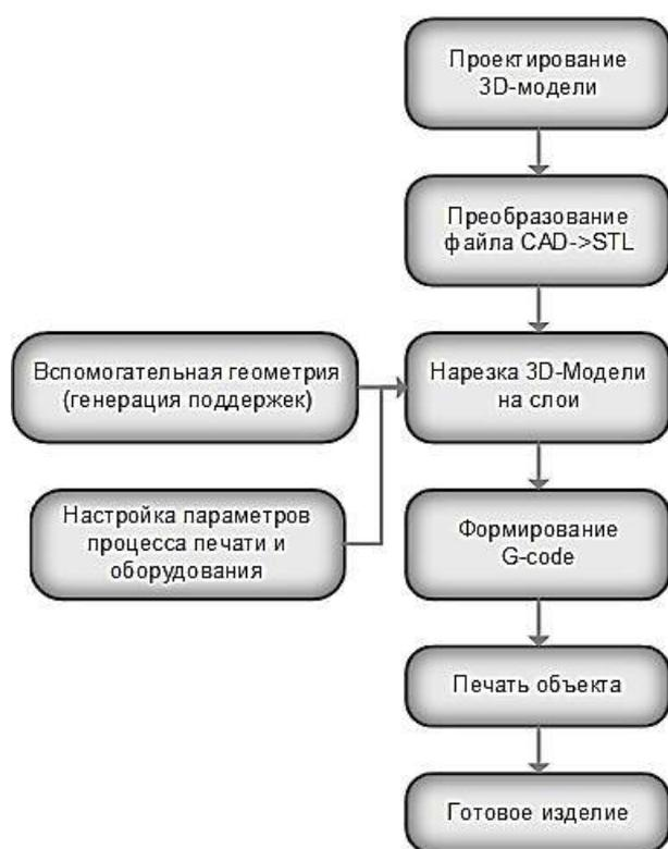
Рис. 2. Технологические процессы создания объекта
