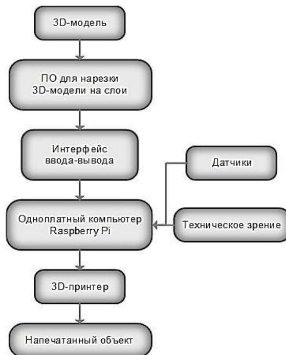
Рис. 3. Модель технологического процесса АП на основе технологий IoT
